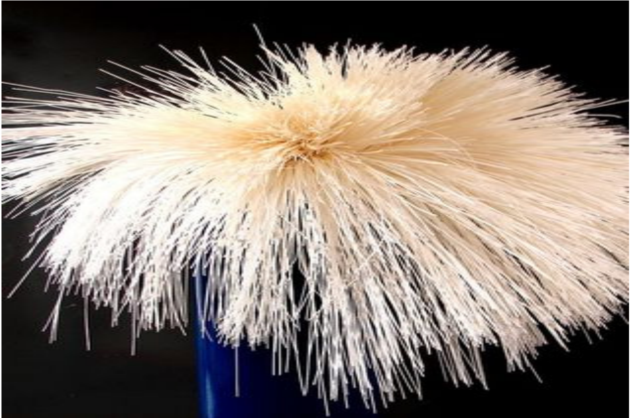
membrana de dessalinização desenvolvida pelo pesquisador - Roberto Bentes de Carvalho
